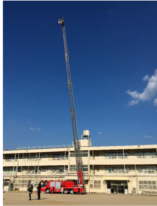
40メートル(ビル12階)の高さまで延伸
